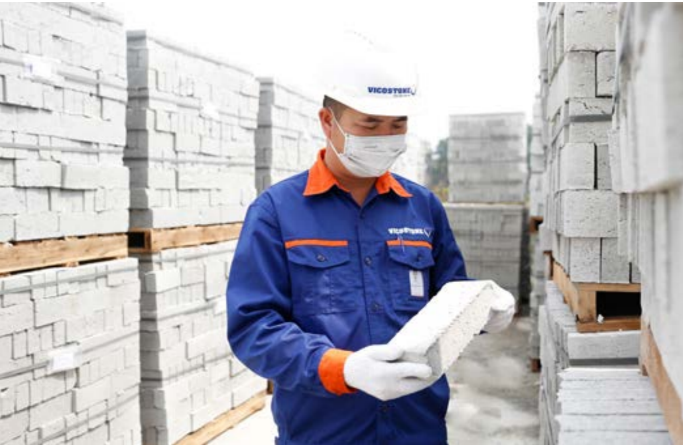
Sản phẩm gạch không nung được tái chế từ bột đá thải từ quá trình sản xuất đá thạch anh
