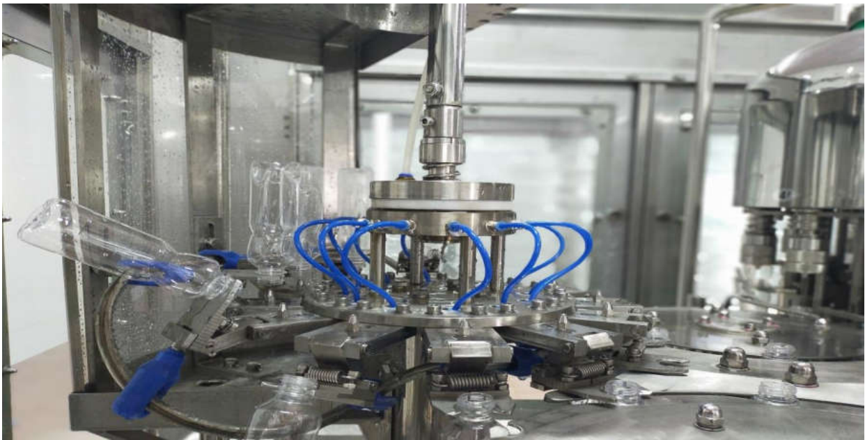
Hệ thống chiết rót chai
